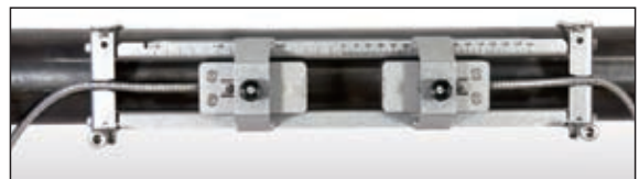
使用手持式Variofix VP安装探头
